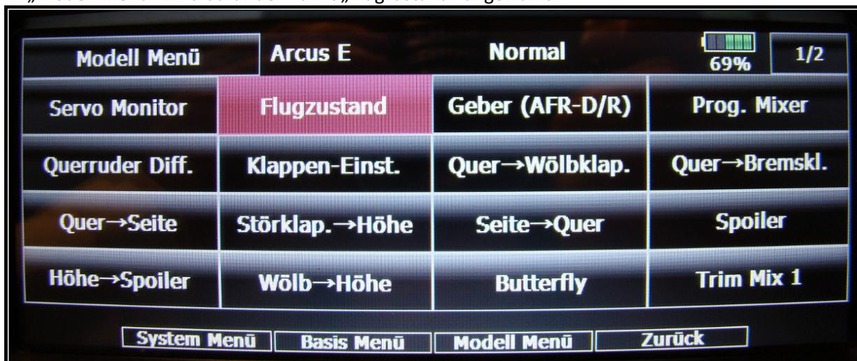
Es wird der Flugzustand „Start“ hinzugefügt und der Schalter für das Ausfahren des Triebwerks zugeordnet.
