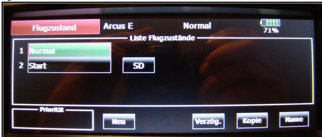
Da man im Segelflug auf der Ratsche die Störklappen fliegt, beim Steigflug aber dort die Motorregelung benötigt, muss man als Nächstes mit dem Umschalten vom Flugzustand Normal auf Start einen Geberwechsel für die Ratsche programmieren. Die Störklappen werden dafür auf einen freien Geber umgelegt, den man im Flug nicht benötigt. Bei mir, in diesem Fall, der versenkbare Drehgeber LD, der auf rechtsanschlag steht, damit die Klappen eingefahren bleiben, wenn ich das Triebwerk ausfahre.
